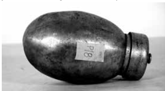
7. Prefabrykat (bez przetoczeń) aluminiowej manierki żołnierskiej wz. 37; archiwum Muzeum Historii Kielc
