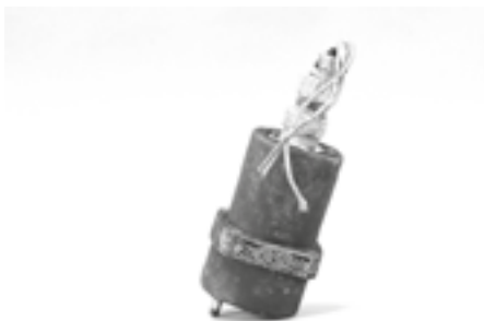
Mechanizm sterowania zaworu nadmiarowego dołotu powietrza do turbosprężarki silnika Wright R-1820-97
