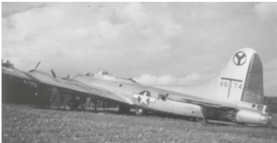
Samolot B-17 G nr 44-6674. Widoczne uszkodzenia lewego statecznika poziomego. Fot. ze zbiorów Andrzeja Sławińskiego
