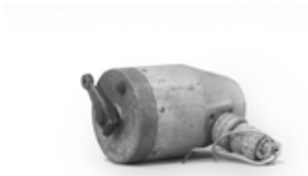
Mechanizm sterowania zaworu nadmiarowego dołotu powietrza do turbosprężarki silnika Wright R-1820-97
